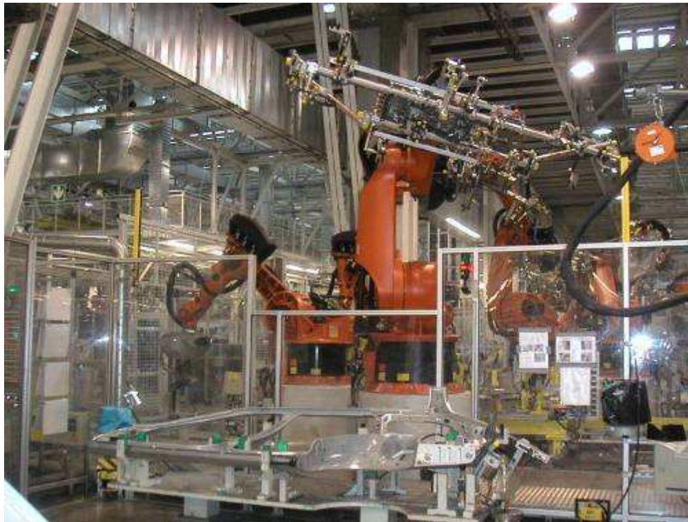
Roboterzelle in Karosseriefertigung
